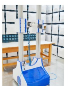
■ 高频俯仰天线塔
