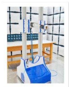
■ 高频俯仰天线塔
