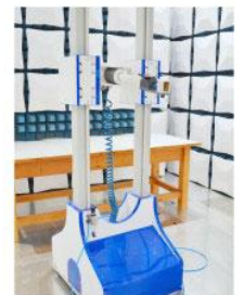
■ 高频俯仰天线塔
