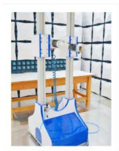
■ 高频俯仰天线塔
