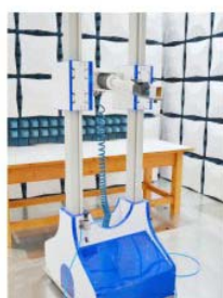
■ 高频俯仰天线塔
