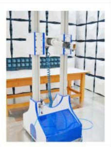
■ 高频俯仰天线塔
