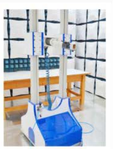
■ 高频俯仰天线塔
