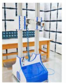
■ 高频俯仰天线塔
