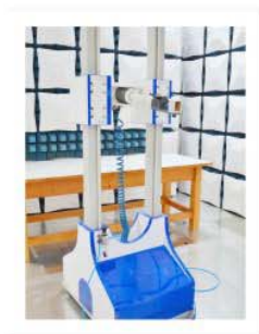
■ 高频俯仰天线塔
